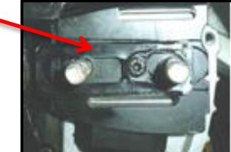
Обязательно удалите из под крышки пластмассовую транспортировочную пластину или кольцо (если предусмотрено конструкцией). Пластина (кольцо) предназначена только для транспортировки пилы.
