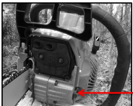
1. Заполните топливный бак свежеприготовленной топливной смесью.
