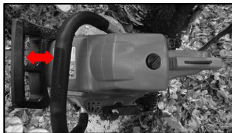
В случае возникновения отскока, при резком поступательном движении пилы вверх/назад, под действием сил инерции рукоятка тормоза движется вперед и преодолевая усилие пружины активирует тормозной механизм. Барабан сцепления мгновенно блокируется и цепь останавливается.
