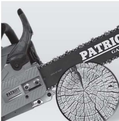
Не стоит придавать усилия при распиловке древесины, собственный вес пилы позволяет вести процесс распиловки. Если цепь зажала, остановите двигатель, приподнимите или измените положение бревна. Не стоит дергать инструментом для освобождения цепи.
