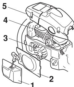
Производите очистку системы охлаждения щеткой раз в неделю или чаще, если этого требуют условия работы. Загрязненная или засоренная система охлаждения может привести к перегреву машины и вызвать повреждение поршня и цилиндра.
