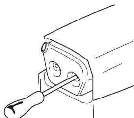
В некоторых глушителях предусмотрен специальный искрогаситель. Если ваша машина оборудована таким глушителем, сетку фильтра следует чистить раз в неделю. Наилучше пользоваться стальной щеткой. Забитая решетка приводит к работе с горячим двигателем, что дает серьезные повреждения двигателя.
