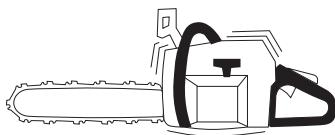
Проверьте, чтобы виброгасящие элементы были надежно закреплены на блоке двигателя и ручках.
