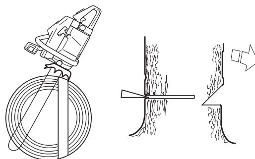
Закончить основной пропил нужно параллельно линии направляющего пропила так, чтобы расстояние между ними составляло около  $1/10$  диаметра ствола. Нераспиленный участок ствола называется полосой разлома (недопил).
