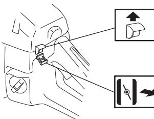
Если машина укомплектована топливным насосом (A): Сожмите несколько раз резиновую грушу топливного насоса пока в нее не начнет поступать топливо. Грушу нет необходимости заполнять полностью.
